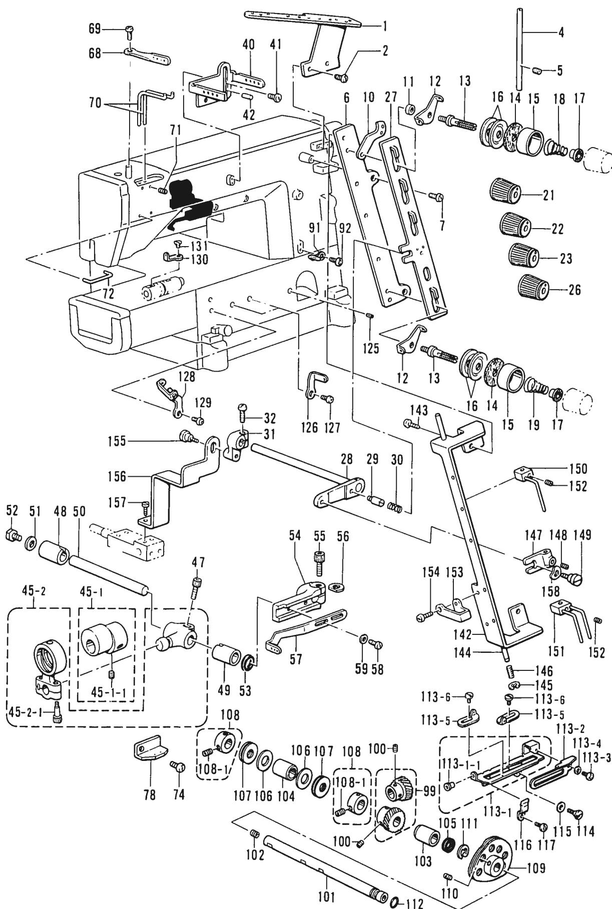
K1. 糸調子関係 (B256)/Thread tension/Faderspannung/
