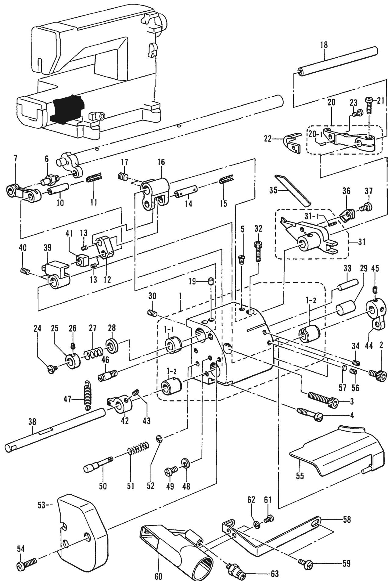
N1. トリンギングメス関係 / Trimming knife mechanism / Fadenabschneidemessereinheit /
