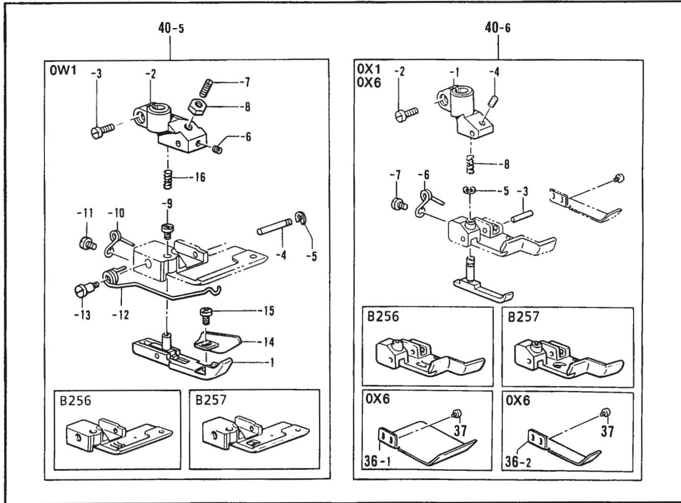
D. 針冷却装置 / Needle cooler / Nadelkühlungsvorrichtung /
