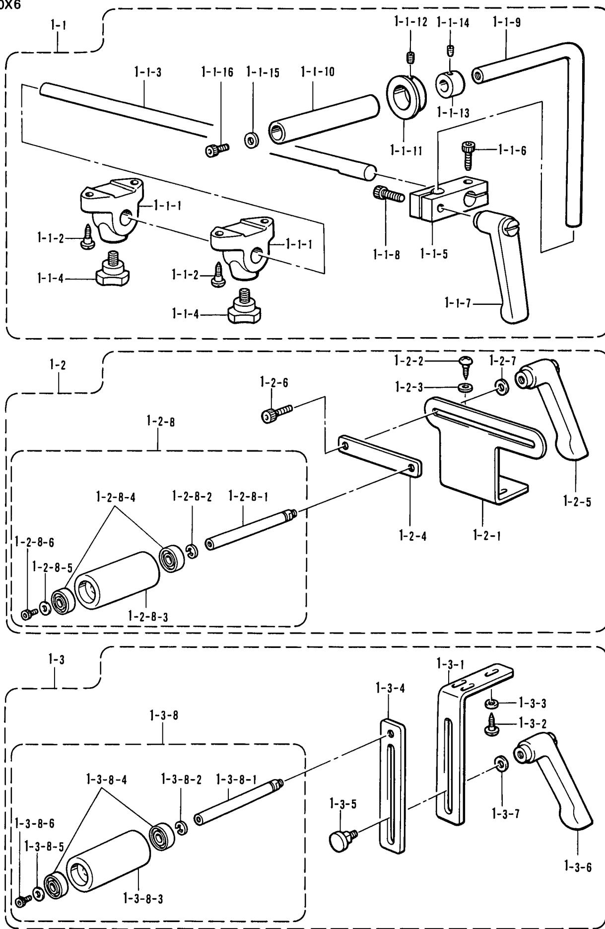
**W1. 布張ローラ装置関係 /Fabric tension roller device set/Stoffspannrollervorrichtung/
