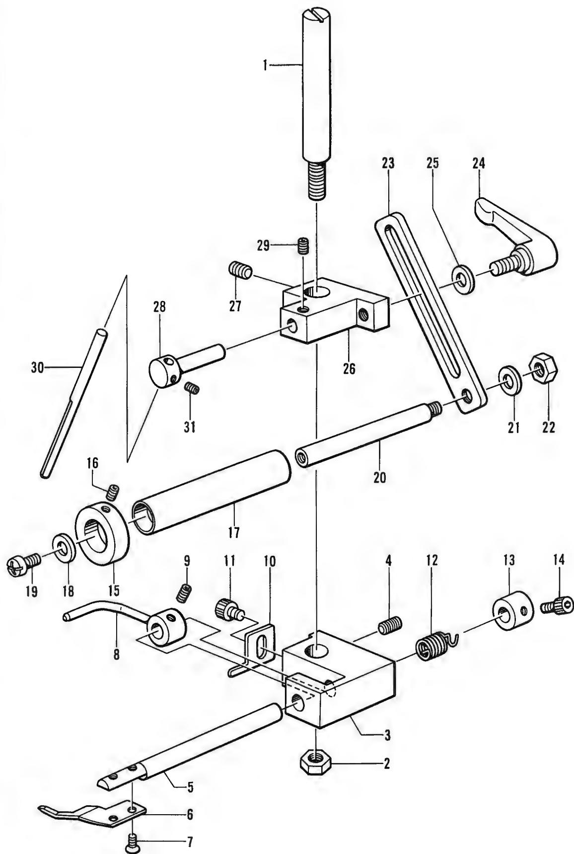
P. 縫製アタッチメント関係 /Sewing attachment mechanism/Zusatznähvorrichtung/
