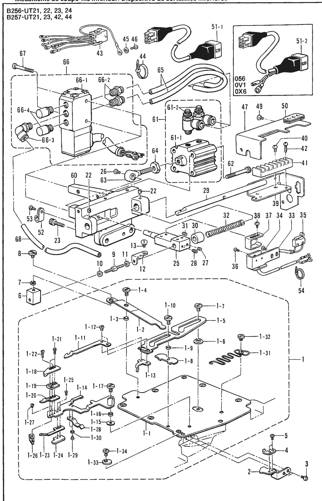
S2. 下飾り糸切り関係 /Lower thread trimmer mechanism/Unterfadenabschneider/
