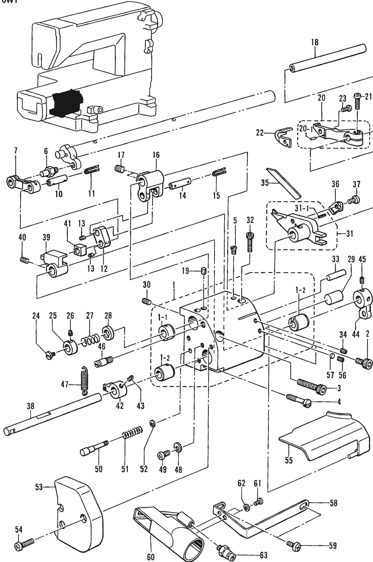
N1. トリミングメス関係 / Trimming knife mechanism / Fadenabschneidemessereinheit /
