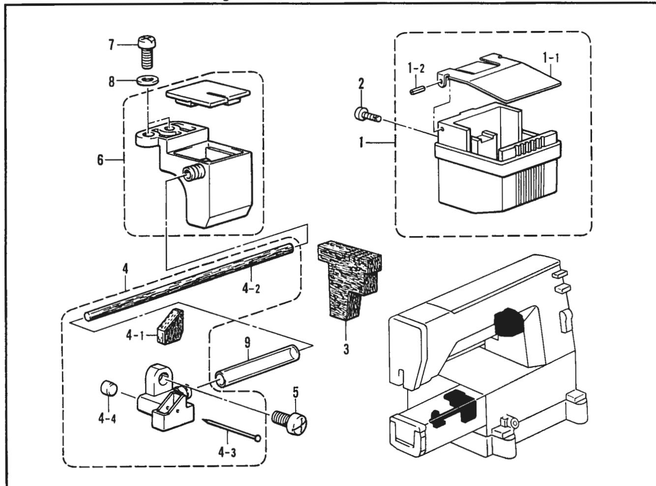
C2. 押工関係 / Presser foot mechanism / Stoffdrückerfuß /
