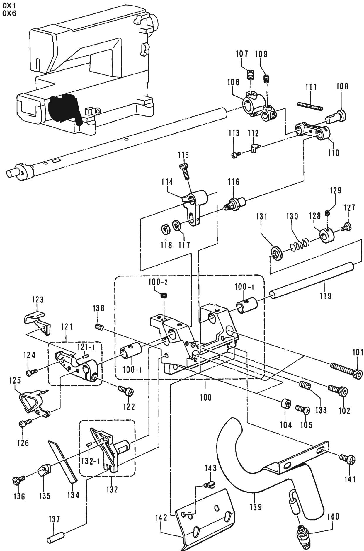
N2. トリンギングメス関係 / Trimming knife mechanism / Fadenabschneidemessereinheit /
