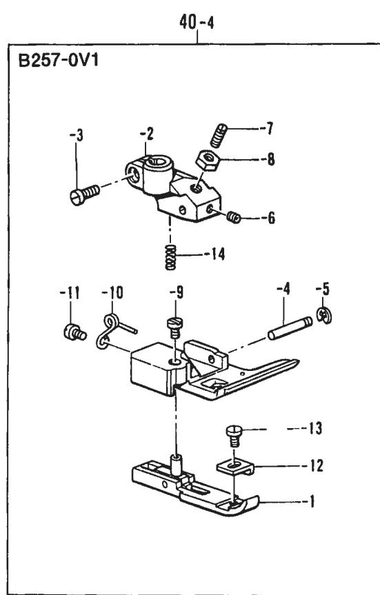
C2. 押工関係/Presser foot mechanism/Stoffdrückerfuß/
